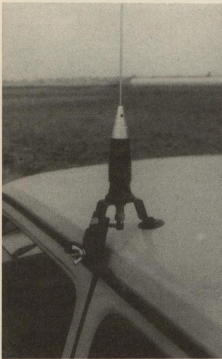
Rys. 10. Antena 5/8 λ zamontowana na ryniencie dachowej
