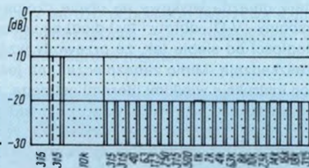
Rys. 3. Test na kasiecie pomiarowej laboratoryjnej hifi ( 4,76/3,81 \text{ Fe} )
