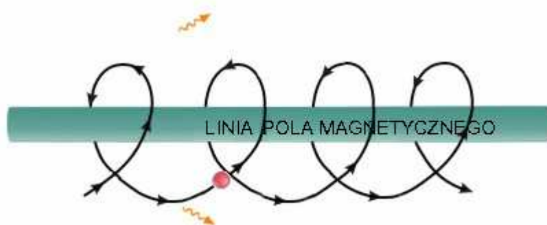
Rys. 4.1. Powstawanie promieniowania cyklotronowego
