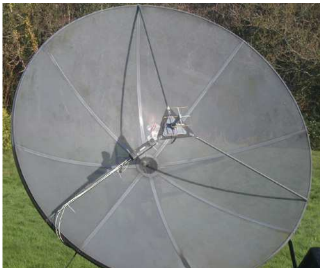
Fot. 3.8. Antena paraboliczna o średnicy 3 m na pasmo 408 MHz; f/D = 0,28 .
