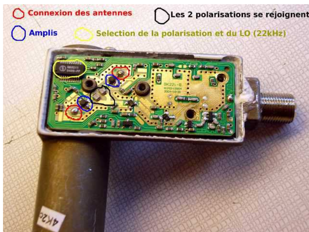
Fot. 7.7. Płytką drukowaną z zaznaczonymi najważniejszymi częściami układu. Na czerwono zaznaczono miejsca podłączenia anten, na czarno miejsce połączenia kanałów obu polaryzacji, na granatowo – wzmacniacze i na żółto układ przełącznika polaryzacji i zakresu (oscylatora).
