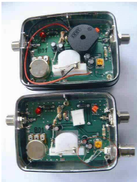
Rys. 2.3. Przykładowy schemat miernika satelitarnego
