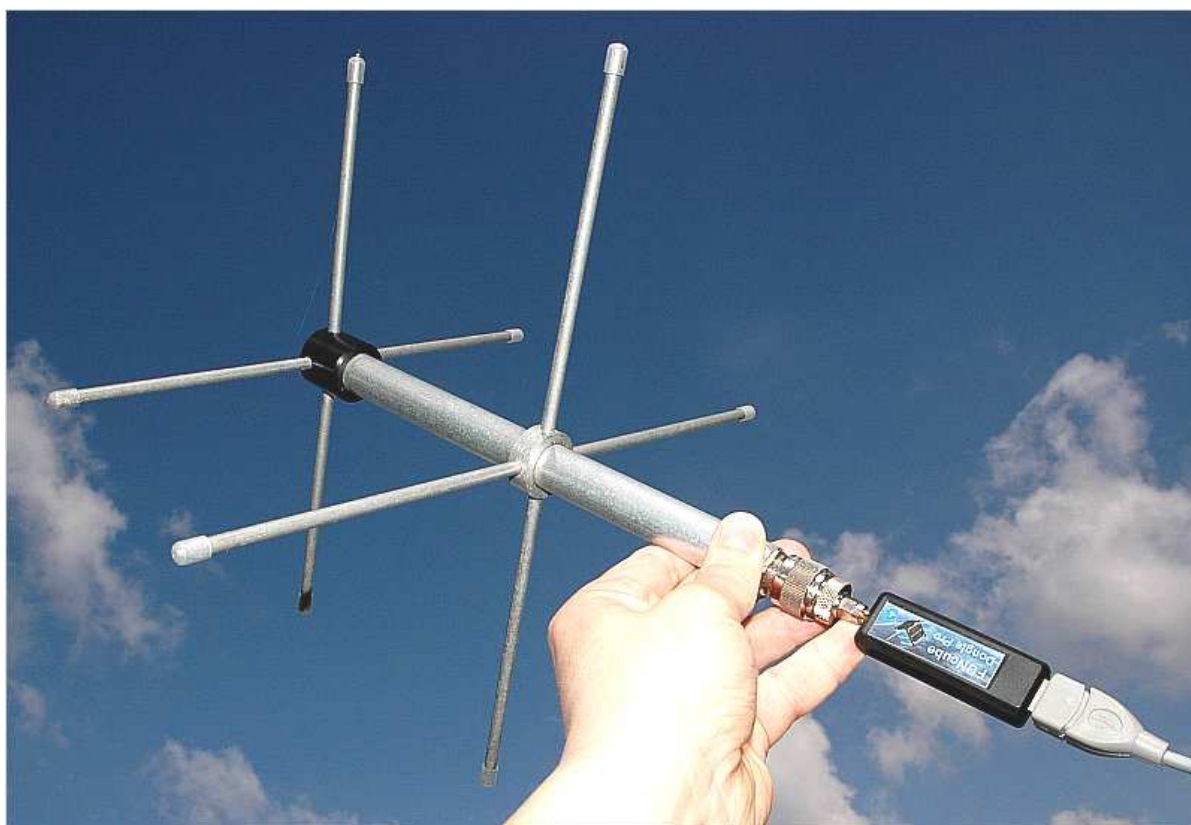
Fot. 3.12. Odbiór satelitów z wykorzystaniem anteny ręcznej na pasmo 2 m
