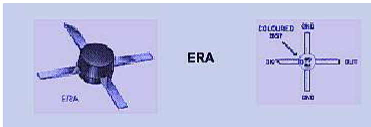
Rys. 6.3. Obudowa i wyprowadzenia MMIC. Kolorowa kropka i ścięta ukośnie elektroda oznaczają wejście, wyjście znajduje się po przeciwnej stronie, a pod kątem prostym do tej linii znajdują się doprowadzenia masy.
