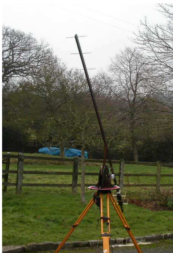
Fot. 3.6 Przykład anteny radioastronomicznej na pasmo 408 MHz. Zysk ok. 16 dBi, szerokość pasma ok. 40 MHz.
